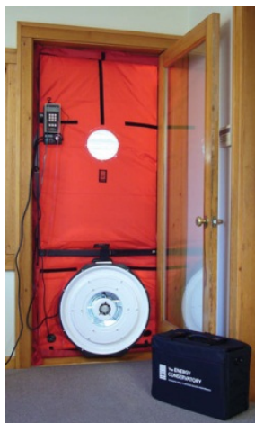
Uitvoeren van een blowerdoortest
